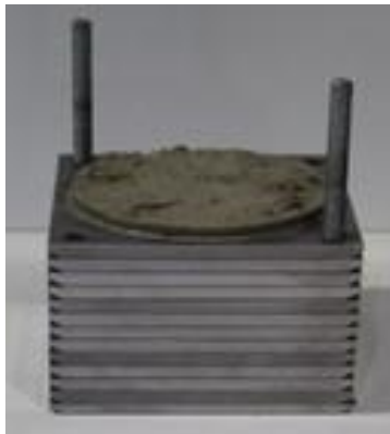
Probengestell mit zur Probenentnahme freiliegender Betonschicht
