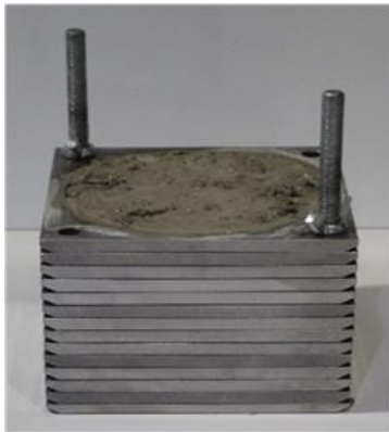
Mit Beton gefülltes Probengestell
