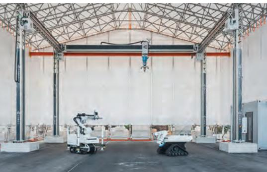
Herzstück der Digitalen Baustelle ist die rd. 6 m hohe 3D-Druckeinheit, mit der großformatige, individualisierte Bauteile additiv hergestellt werden sollen.
