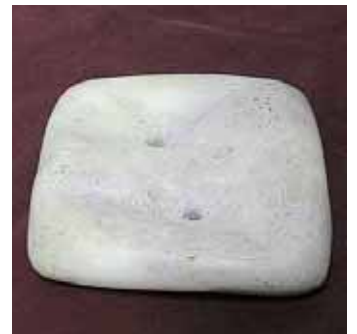
Der ungeschmückte Rohling des Kissens, der nach der Vermessung des Originals im Rapid-Prototyping-Verfahren entstanden ist.
